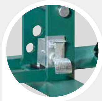
Fotmanövrerad, tryckluftsstyrd snabbmatning av kolven till arbetsstycket.
